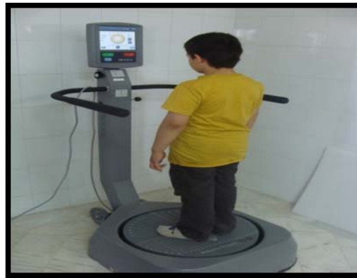
شکل ۱. روش اندازه گیری تعادل با استفاده از بایودکس
